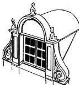
lucarne-fronton ici à ailerons et toit bombé
