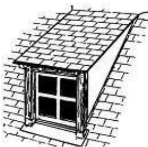
lucarne rampante ou en chien couché
